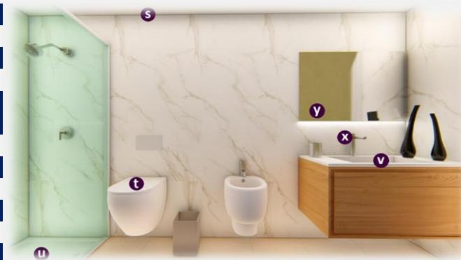
Teto falso contínuo em gesso cartonado hidrófugo **s**
